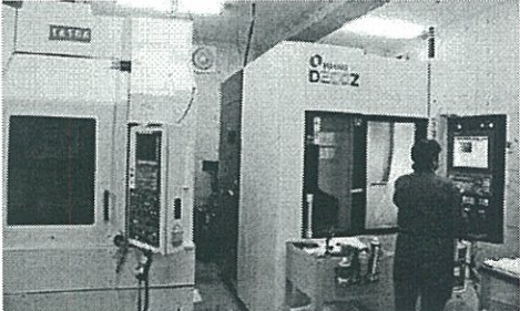
マシニングセンターと呼ばれ、コンピュータの指示に従って機械が自動で作業してくれる
